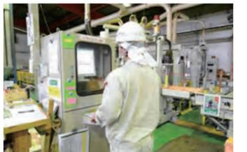
CADよりCAMに変換されたデータを確認し、邸宅別に機械へデータを送る
