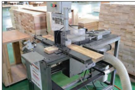
**短尺間柱欠加工機**
