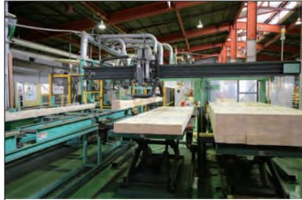
**柱材料自動投入装置**
