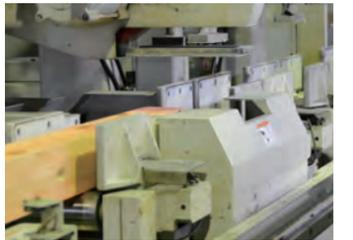
データに従って、長さや幅、高さなどを正確に測定し加工する
